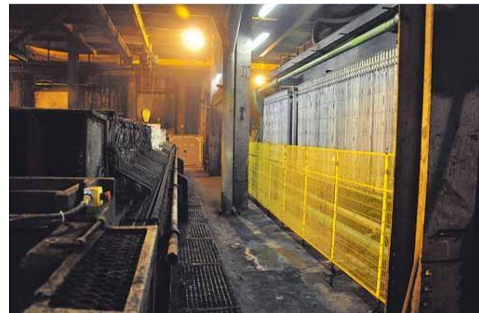
Nowa prasa, na zdj. z prawej, jest znacznie większa od dotychczas stosowanych pras typu PF ROW – z lewej.
