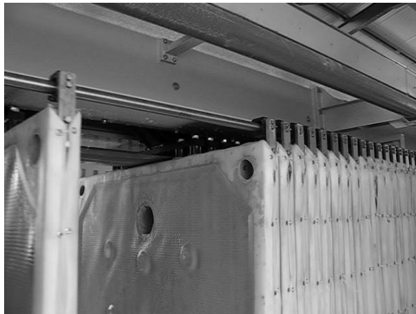
Rys. 2. Górne podwieszenie płyt [źródło: opracowanie własne]
