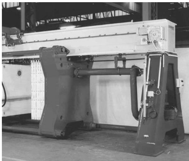
Rys. 6. Ruchoma głowica podwieszona do górnej belki [źródło: opracowanie własne]
