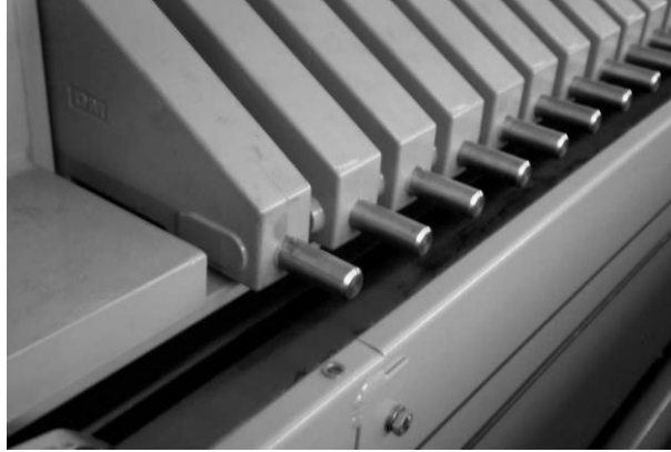
Rys. 1. Boczne podparcie płyt [źródło: opracowanie własne]
